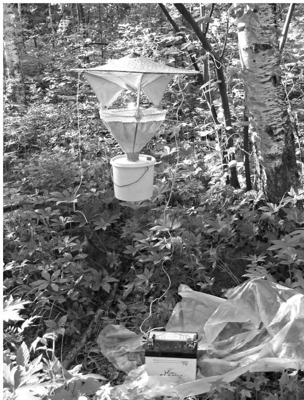
Рис. 1. Работающая от аккумулятора светоловушка с лампой 20 W, 12 V, внешний вид. Аккумулятор открыт для показа соединения.
