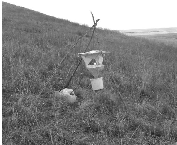
Рис. 2. Работающая от аккумулятора светоловушка, расположенная на треноге в степи, внешний вид.
